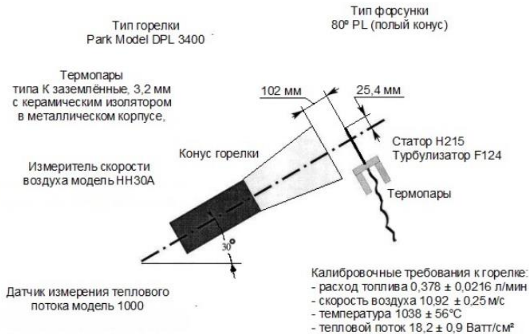
Рис. 8. Информация о горелке и процедуре её калибрования
