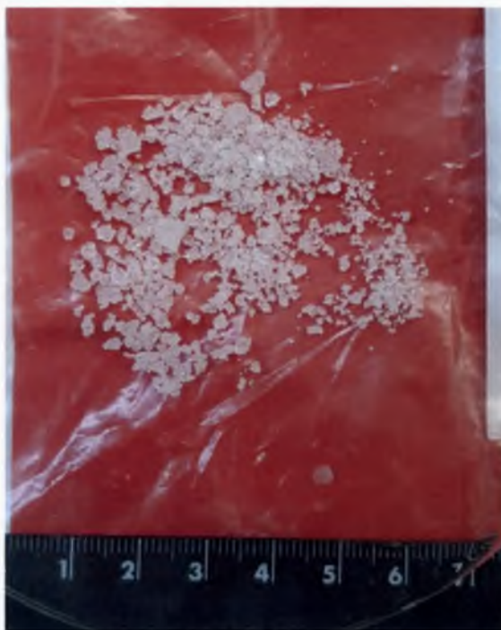
Фото 2. Отложения, отобранные из L/H transfer ejector pump (from motive-fluid nozzle) BC CRJ-200 VP-BVK АО АК «РусЛайн»
